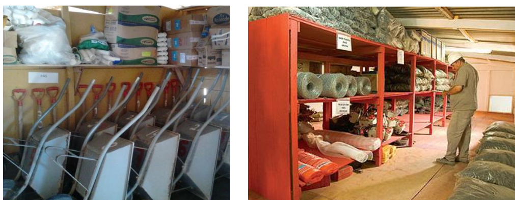
Fig. 2 e 3 - Exemplos de utilização da técnica 5S em armazens de obra.
