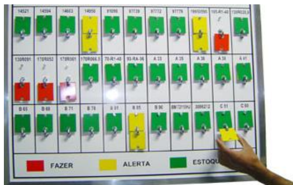
Fig. 1 - Quadro de cartões para controlo de atividades de um processo
