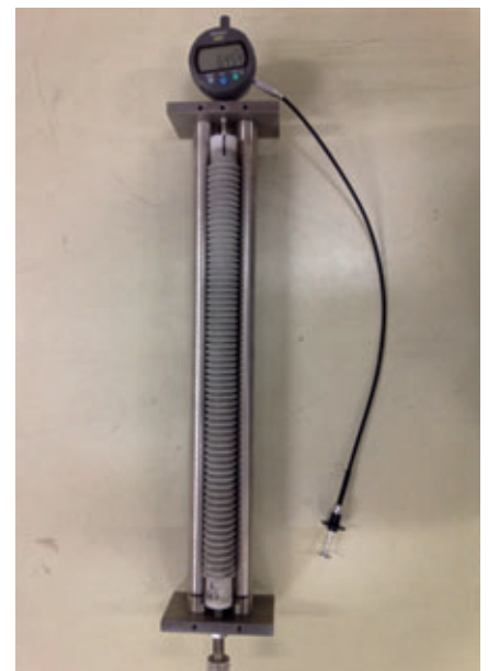
Fig. 9: Verificação da contração autógena por procedimento de tubo reforçado
